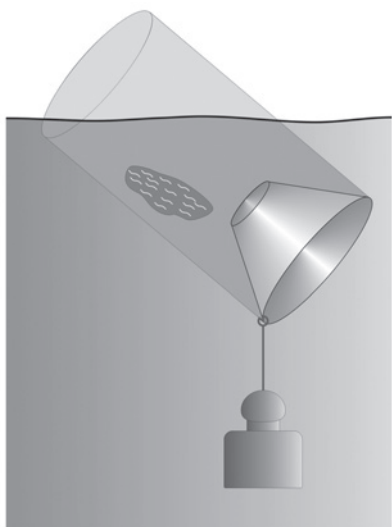
Sl. 5: Izvedba vodne pasti za vzorčenje mesojedih vodnih hroščev, zlasti kozakov (Dytiscidae) (risba A. Kapla).
