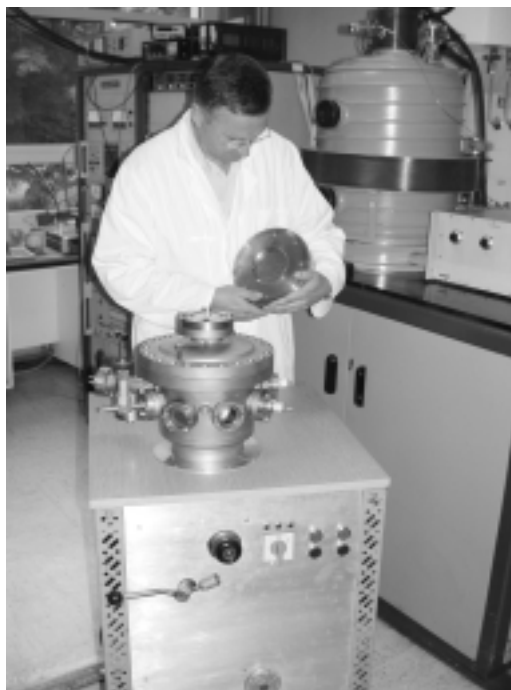
Slika 1: Balzersova eksperimentalna naprava Sputron (v ozadju), v kateri smo leta 1982 naredili prve TiN-prevleke na ploščate rezalne ploščice, in doma konstruirana naprava (v ospredju), v kateri smo lahko nanašali TiN-prevleke na orodja s komplicirano geometrijo (npr. svedri). Preizkusi orodij v industrijski proizvodnji so bili zelo spodbudni.
