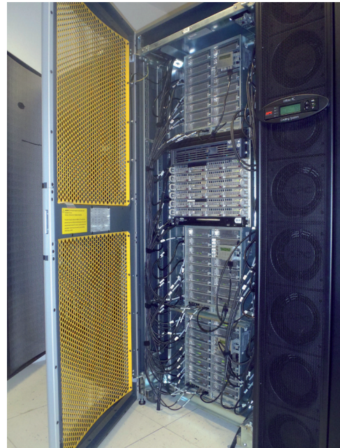
Slika 4. Računalnik SGI ICE 8200, trenutno operativni računalnik za izvajanje numerično intenzivnih aplikacij na ARSO.
