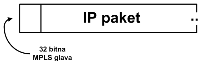
Slika 3: Dodajanje 32 bitne MPLS glave
