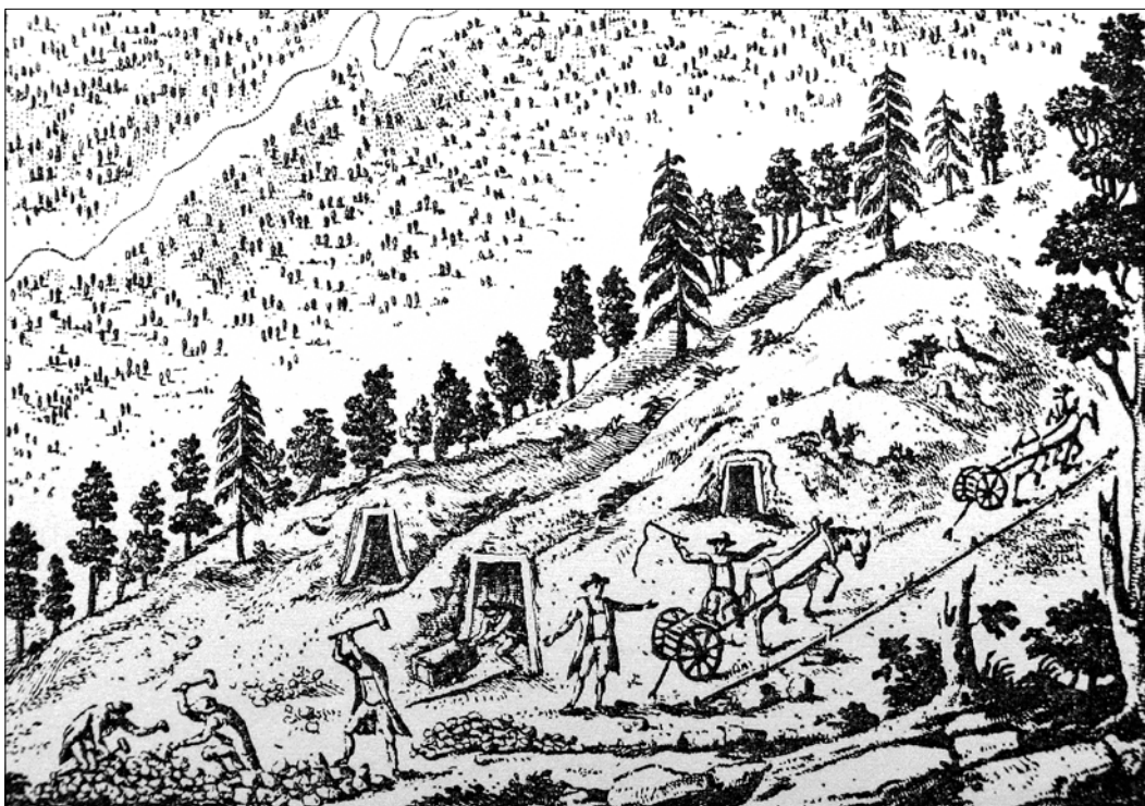
Slika 2: Rudarjenje na Pohorju. Izkop in izvoz rude iz rudniških jam, razbijanje večjih grud in prevoz rude z enoosnimi vozovi k Zoisovemu plavžu v Mislinjskem jarku. Posekana drevesa okoli rovov so uporabili za stojke, opaž, vozičke idr. (B. Hacquet: Oryctographia Carniolica , III. zvezek, Leipzig 1784).
