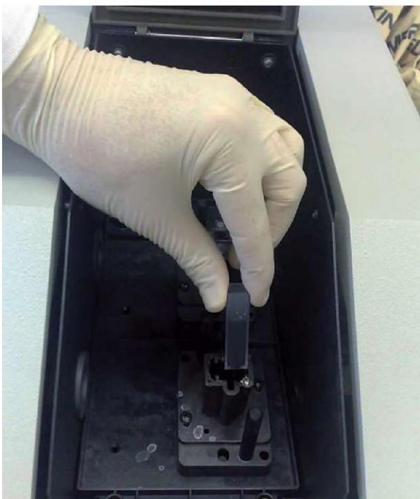
Slika 2. Vstavljanje vzorca v merilno celico UV-VIS spektrofotometra (foto: V. Vek).
