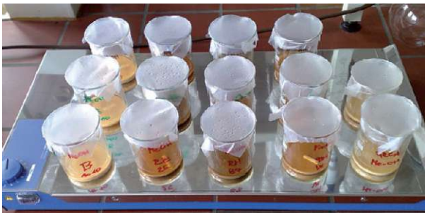
Slika 1. Hladna ekstrakcija lesa z večmestnim magnetnim mešalom (foto: V. Vek)
