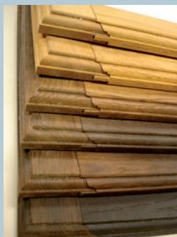
Izdelki iz modificiranega lesa so dimenzijsko bolj stabilni
