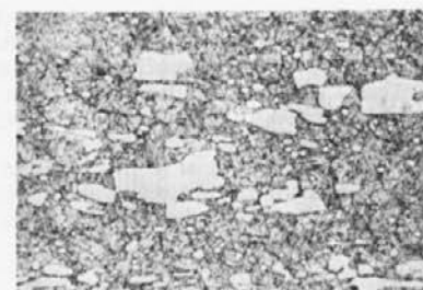
Sl. 6: Pogled pri večji povečavi — jeklo z 1,65% C, 12% Cr, 0,8% Mo in 1% V. Trdih kromovih karbidov je okoli 15%. Povečava 500X.
