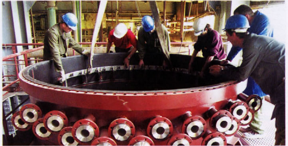
V filter so že nameščeni nosilni obroči in vseh osemnajst nosilnih cevi
