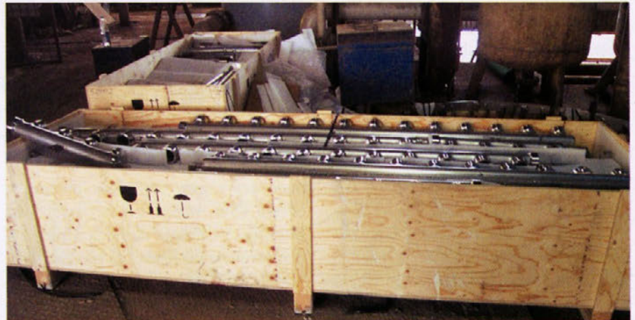
Pogled na registre, pripravljene za montažo
