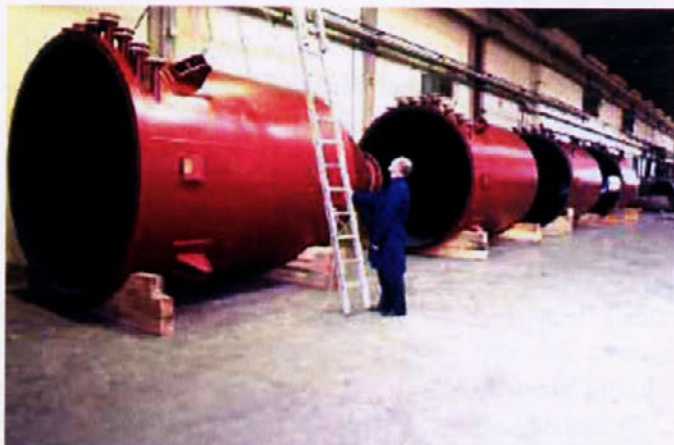
Filtri po prevzemu čakajo na montažo pokrova in transport na gradbišče
