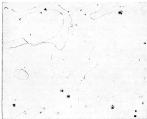
Slika 7 ( \times 500 ) lito stanje — žarjeno 12 ur pri 1250° C, ohlajeno v vodi
