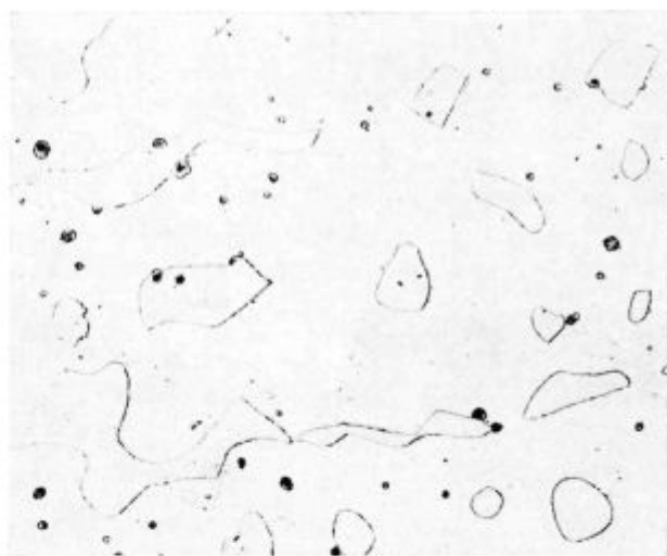
Slika 8 ( \times 500 ) lito stanje — žarjeno 12 ur pri 1250° C, ohlajeno v vodi
