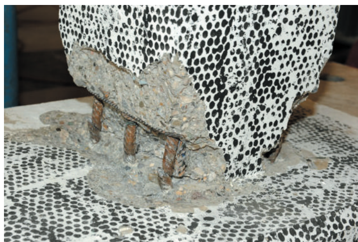
Slika 8 • Pogled na stebri SU-A-1 pri 7-% zasuku (levo) in pogled na vpetje z vidno pretrganimi armaturnimi palicami (desno)
