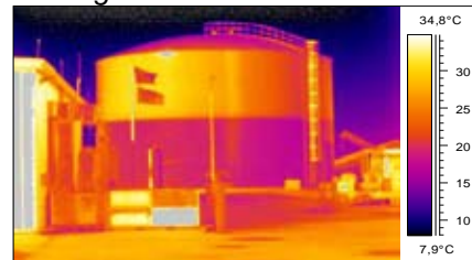
Termogram rezervoarja s tekočino
