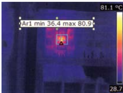
Slika 2: Vroča točka v električni omarici
