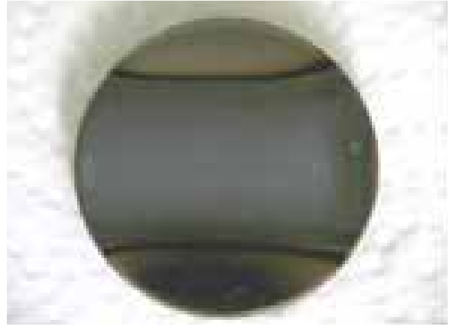
Slika 2: Robotsko lasersko kaljen vzorec s hitrostjo 2 mm/s in kalilno temperaturo 1000 °C
