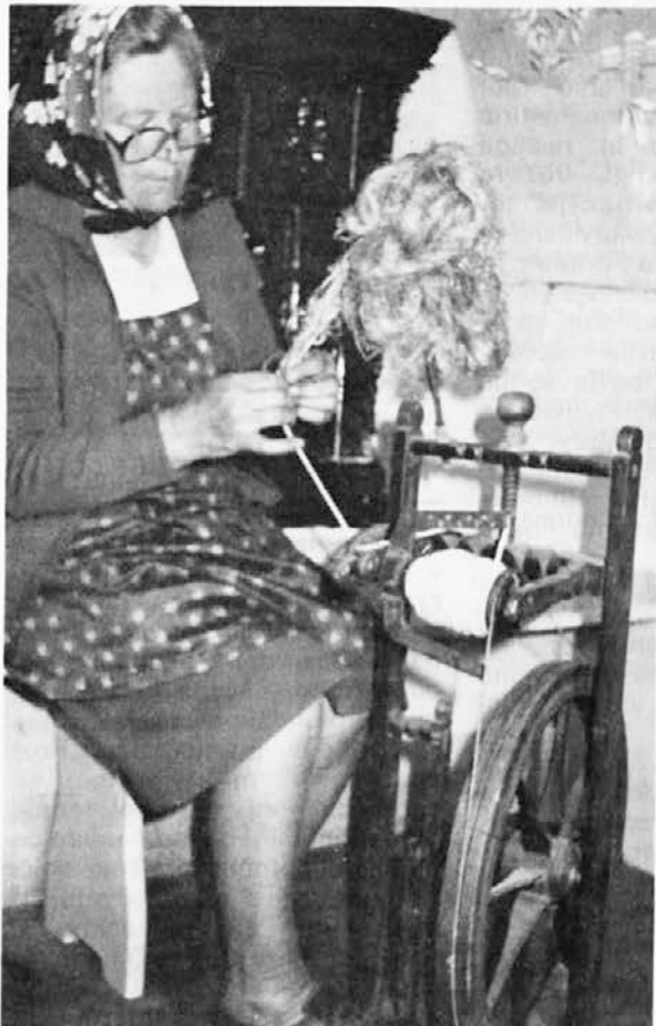
PREDICA s kolovratom. S spretnimi rokami iz prediva suka nit, ki se navija na klopčič.
