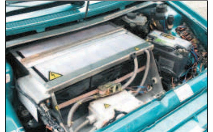
Pod sprednjim pokrovom motorja se skrivajo trije akumulatorji, v prtljajniku pa so še trije. Z njim lahko opravi 100 km za ceno enega evra.
