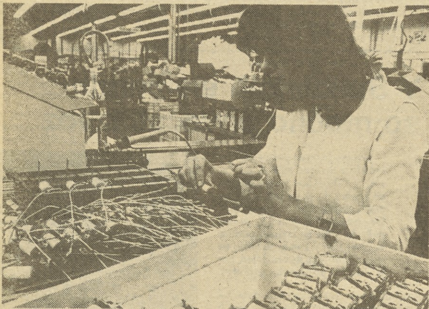
Iz proizvodnje TOZD TEA: tekoči trak telefonskega aparata.
