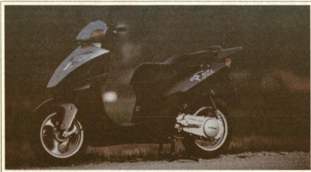
Daelim NS 125 je skuter z dolgim sedežem, z veliko prostora za noge in prtljago (predal pod krmilom in sedežem ter nosilec prtljage za sedežem).
