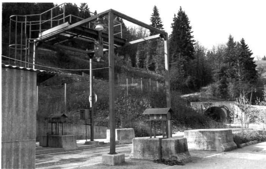
Radiometrična vrata RV-3 z dvema bočnima in z enim visečim detektorjem; v ozadju glavni izvozni rov P-11 na Rudniku urana Žirovski vrh. (foto T. Lunder)
