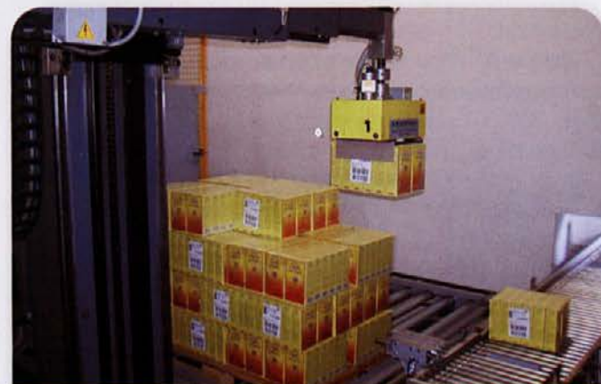
Robot zgrabi paket in ga preloži na paleto.
