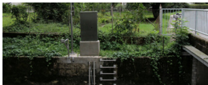
Vodomerna postaja v Loki pri Mengšu in stara merilna lata pod Malnovim mostom. Ročno beleženje dnevni podatkov še vedno poteka zaradi kontrole kakovosti podatkov z nove samodejne postaje.
