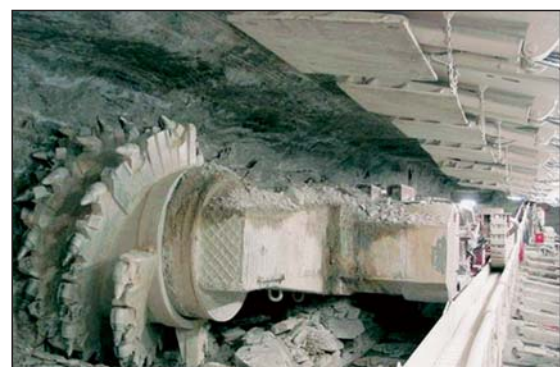
Slika 1. Odkop z rotirajočim sekačem in hidravličnim podporjem [1]
