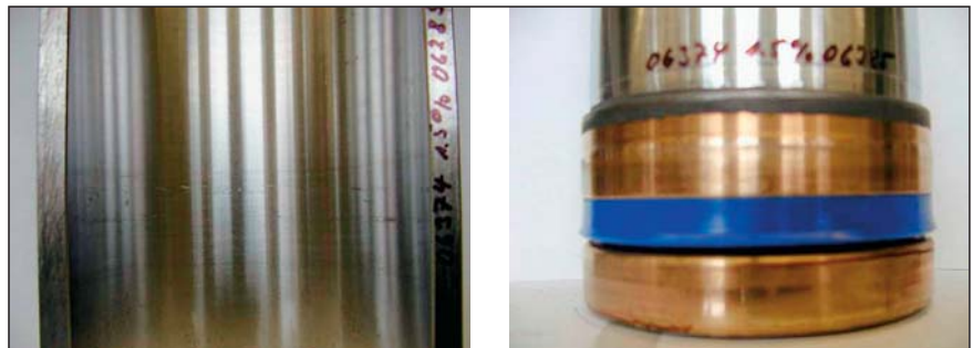
Slika 4. DBT-korozijski test 1,5-odstotne koncentracije Quintolubrica 818-02 v »velenjski« vodi
