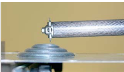
Konturograf Mahr med meritvijo tanjšanja pločevine
