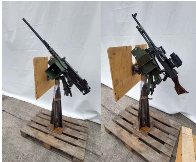
Prototip univerzalnega nosilca LVM-2 z nameščenim orožjem Browning 12,7 mm in PM MAG 7,62 mm
