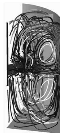
Slika 6: Tokovnice tekočine v mešalniku prikazujejo območja in hitrost mešanja (13)
