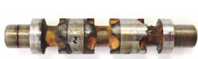
Slika 9 : Krmilni bat AIDRO ventila HD3-AMPS-1PC-R4/10 po štirih dneh neuporabe
