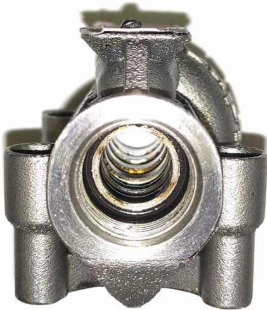
Slika 14 : Ohišje AIDRO ventila HD3-AMPS-IPC-R4/10 po skupno 3 390 000 ciklih pred čiščenjem
