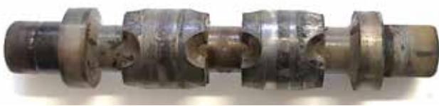
Slika 12 : Krmilni bat AIDRO ventila HD3-AMPS-1PC-R4/10 po 2 000 000 ciklih
