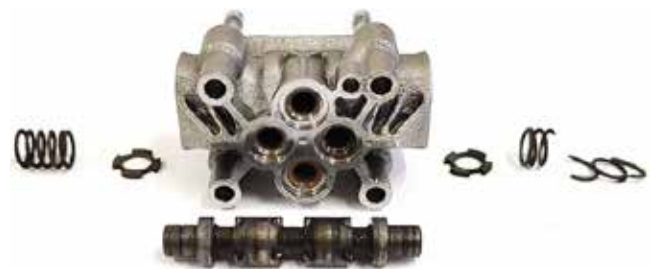
Slika 11 : Spodnji del ohišja brez O-tesnil, krmilni bat, podložki in originalni vzmeti AIDRO ventila HD3-AMPS-1PC-R4/10 po 1 500 000 ciklih
