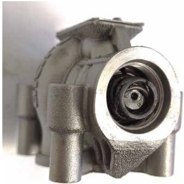
Slika 13 : Ohišje AIDRO ventila HD3-AMPS-1PC-R4/10 z zagosteno originalno vzmetjo
