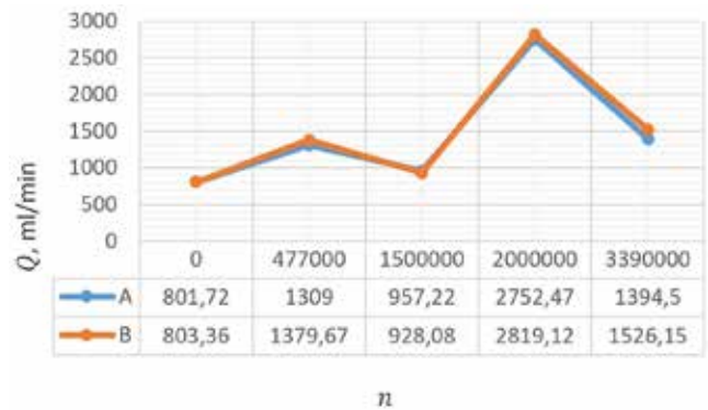
Slika 16 : Spreminjanje notranjega puščanja vode skozi AIDRO-v proporcionalni potni ventil v odvisnosti od opravljenih ciklov s tlakom 300 bar na vodu P
