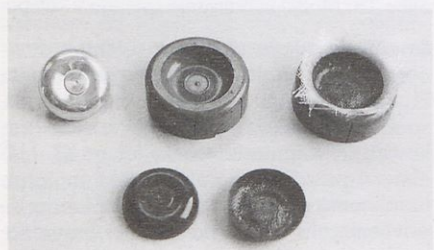
Slika 20. Model, kalup in odliti kolesni polovici
