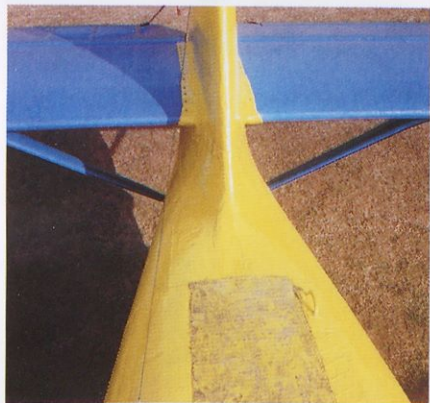
Prehod smernega krmila na trup pri Anuški. Pozornemu opazovalcu ne bosta ušli dve majhni prikovičeni kovinski zaplati na samem korenju, verjetno popravek obrabljenih oplate.
