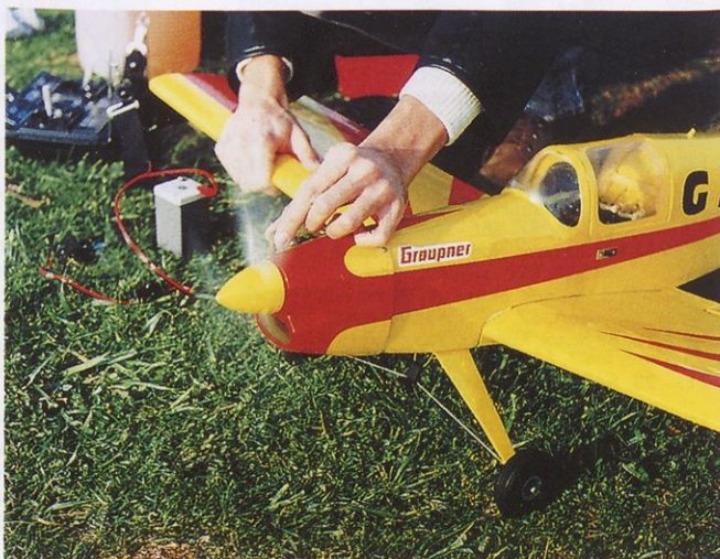
Slika 1. Nastavljanje igle za dovod goriva s sprednje strani je nevarno.
