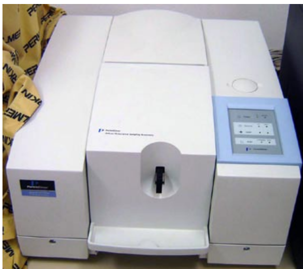
■ Slika 5. Inštrument Spectrum one za merjenje nihajnih (FT-IR) spektrov lesa
