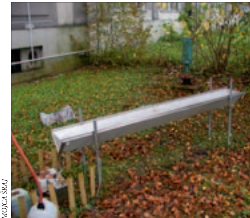
Slika 4: Korito za merjenje prepuščenih padavin, opremljeno z volumetričnim merilcem pretokov (Unidata 6506G, 50 ml/zvrat) in avtomatskim zapisovalcem meritev (HOBO logger).
