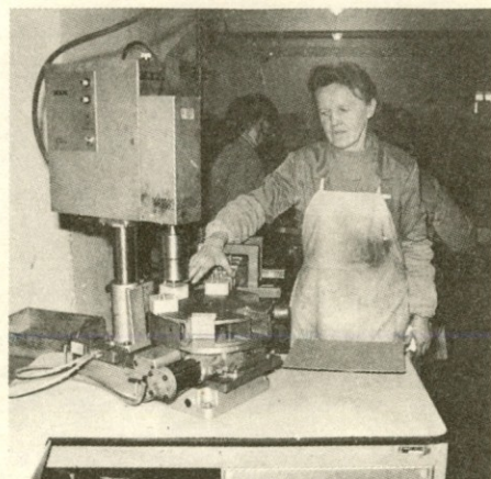
P E T A N Albina pri izdelavi baterij 4R 25 ob stroju za ultrazvočno varjenje
