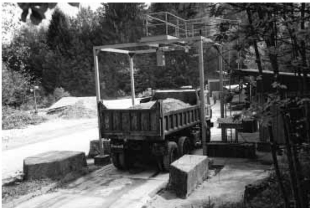
Merjenje teže tovora in vsebnosti urana v njem, pripeljanem iz Žirov dne 17. 9. 2002, radiometrična vrata RV-3
