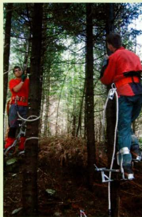
Sadjarke škarje in dereze različnih izvedb so pripomoček za vzpenjanje na drevesa
