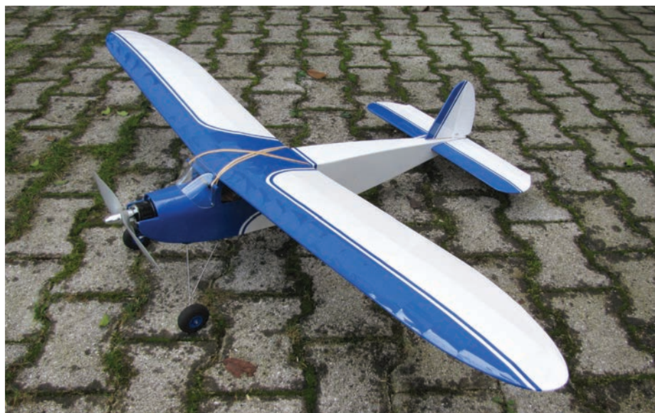
Boris Sekirnik je izdelal model v belo-modri »vintage« barvni shemi. Opremil ga je z RV-napravo in brezkrtačnim elektromotorjem. Model tehta 900 g.
