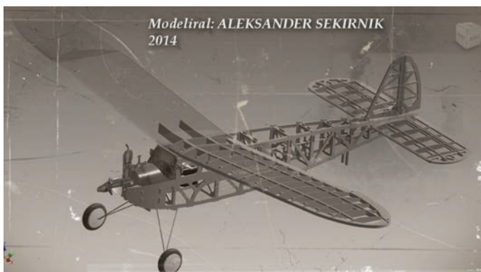
Vse sestavne dele modela smo oblikovali v 3D-tehniko s programom Autodesk Inventor. Zajem zaslona, obdelan s filtrom za postarjanje fotografije, prikazuje, kako bi bil nastajajoči model videti v preteklosti.
