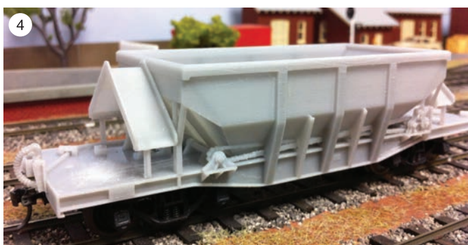
4 Model železniškega vagona, natisnjen z uporabo 3D-tiskalnika [5].
