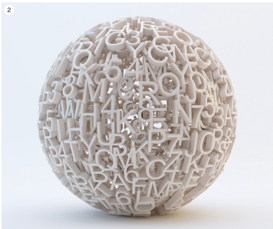
Tako zahtevnega izdelka s konvencionalnimi proizvodnimi tehnologijami ni mogoče izdelati v enem kosu [3].
