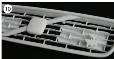
Na približanem posnetku lahko vidimo posamezne plasti, ki jih je ustvaril 3D-tiskalnik [1].
