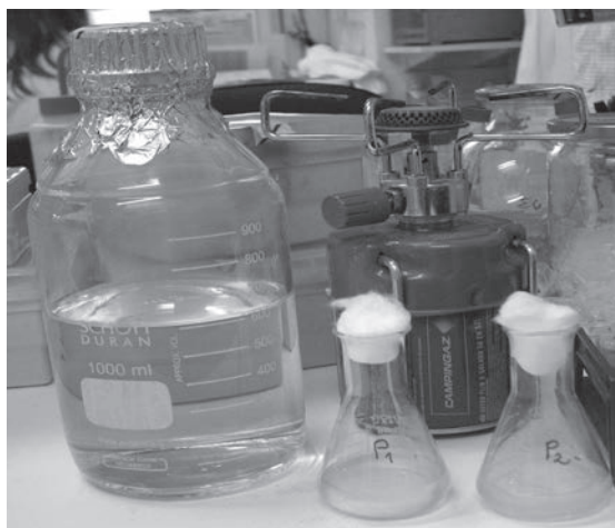
Slika 4: Prelitje vzorcev z nevtralizacijsko tekočino.
