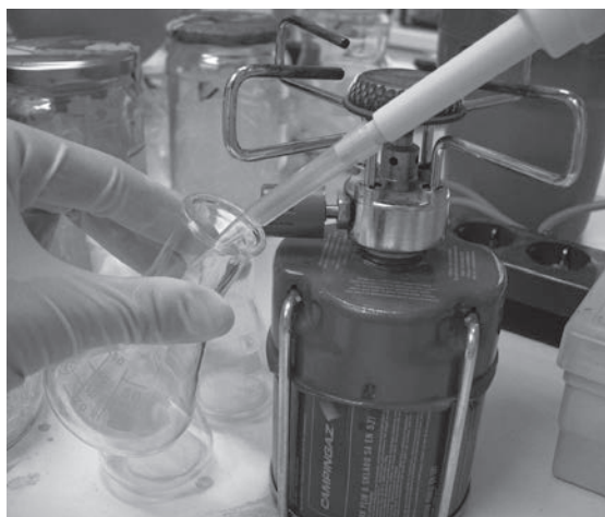
Slika 2: Cepljenje bakterij na vzorec.
