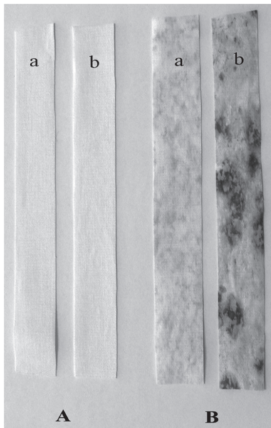
Slika 9: Testni (a) in kontrolni (b) vzorec pred (A) in po devetdnevni inkubaciji v zemlji (B).
