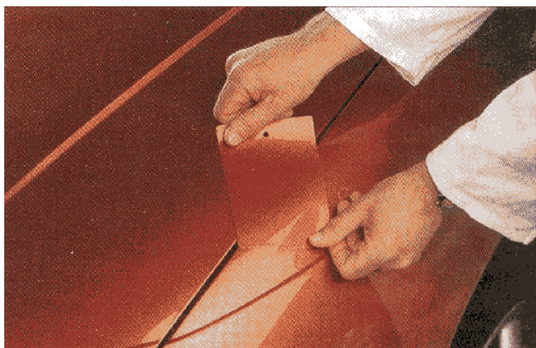
Slika 1: Primerjava barvnih odtenkov na preizkusni pločevini in originalnem lakiranju
