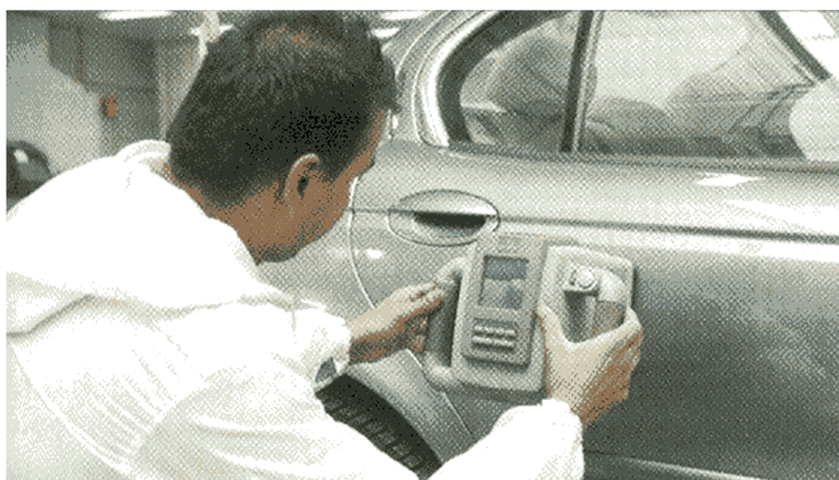
Slika 3: Ugotavljanje barvnega odtenka z barvnim spektrometrom
