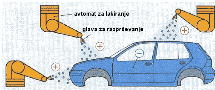
Slika 5: Elektrostatično nanašanje polnila
