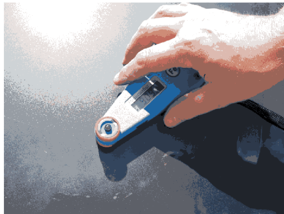
Slika 1: Merjenje debeline lakiranja
