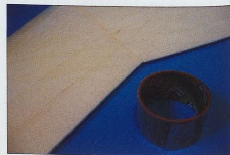
Ko zlepiamo krilni polovici, krilo najprej okrepiamo z lepilnim trakom s steklenimi vlakni.
