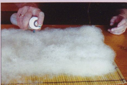
Slika 12. Volneno kopreno enakomerno omočite s pralnim sredstvom s pomočjo pršilke.
