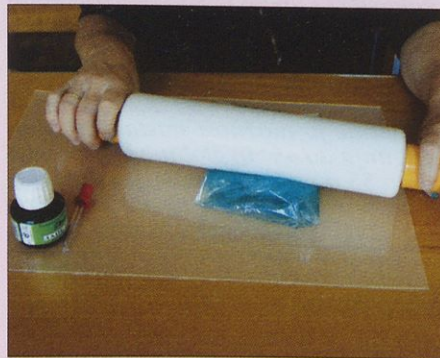
Slika 3. Vrečko s predivom in raztopino barvila povaljajte z valjarjem, da se barvilo enakomerno porazdeli.
