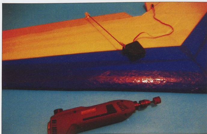
V krilo s poljubnim orodjem izdobljemo prostor za RV-komponente.
