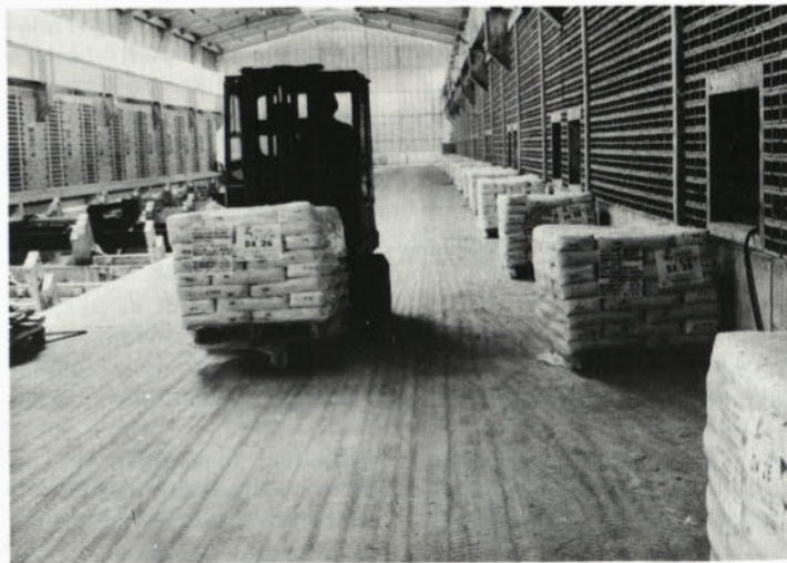
Priprava materiala za obzidavo
