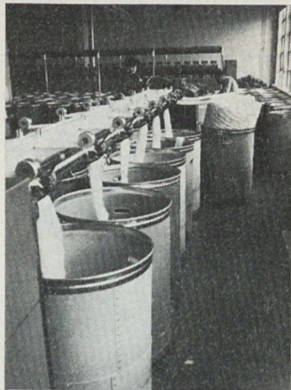
Popravljene raztezalke Intersecting IV že delujejo
