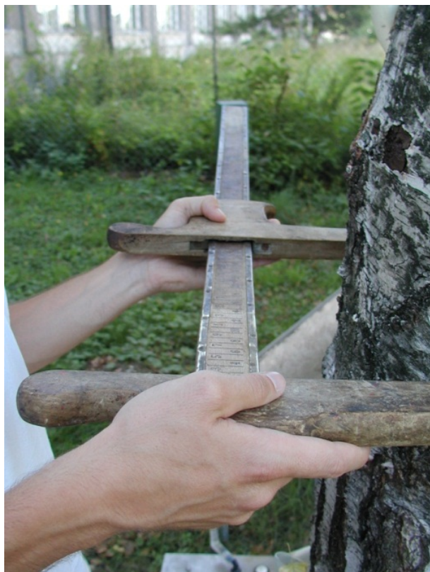
Slika 7: Merjenje prsnega premera drevesa s kaliprom (foto: Šraj).
