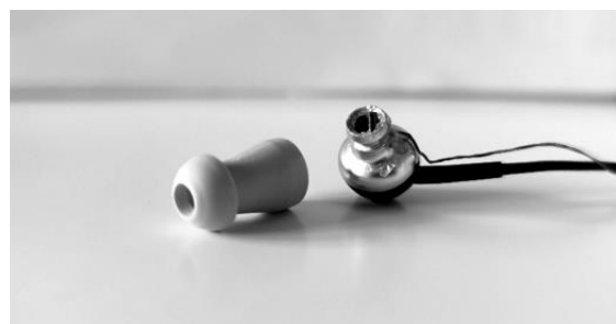
Slika 7 Sennheiser CX100 slušalka z vgrajenim ICS-40619 mikrofonom. Odprtina je dovolj prostorna, da MEMS mikrofonom ne ovira širjenja zvoka.
