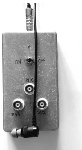
Slika 2 Predojačevalnik s priključeno OAE 25 sondo. Priključimo lahko signale za dva zvočnika in mikrofona v sondi.
