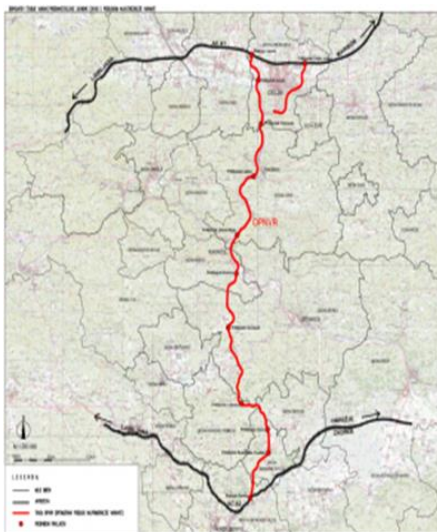
Slika 4: Najustreznejša varianta poteka trase hitre ceste na srednjem delu 3. razvojne osi med avtocesto A1 Maribor–Ljubljana na priključku Celje-Lopata in avtocesto A2 Ljubljana–Obrežje pri Novem mestu, ki jo je leta 2016 izdelal RC Planiranje d.o.o. Celje
