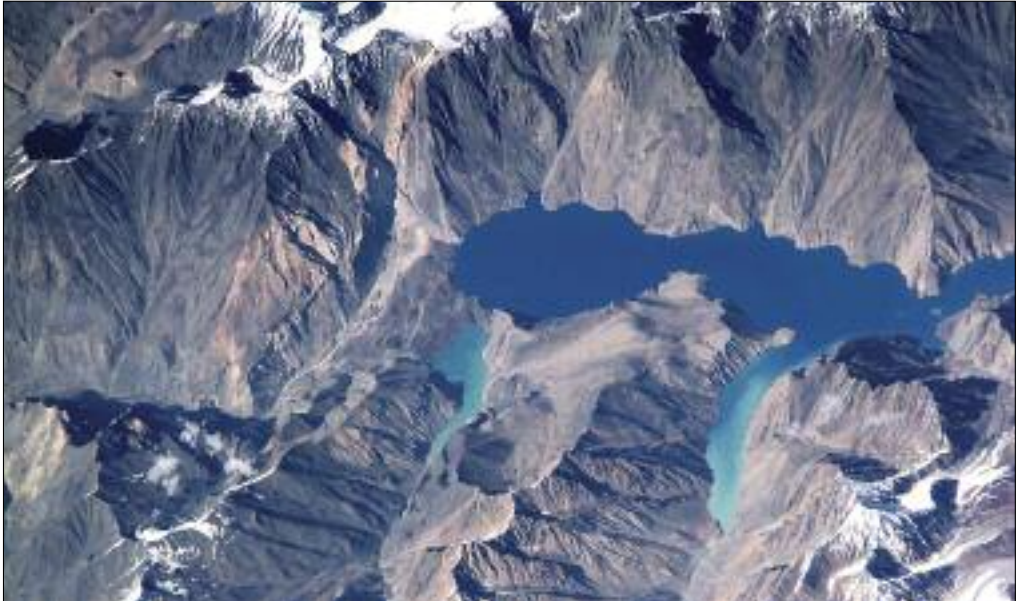
Slika 2: Jezero Sarez v Tadžikistanu, ki je nastalo zaradi obsežnega kamnitega zdrsa ob potresu leta 1911, je dolgo 61 km, globoko 500 m in vsebuje 17 \text{ km}^3 vode. Oblasti se bojijo zdrsov v jezero in posledičnih poplavnih valov, ki bi preskočili jez in povzročili razdejanje dolvodno (medmrežje 1).
