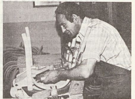
Pri stolah thonetih so prav ogrodni vijaki tisto, kar veže stol skupaj in mu omogoča dolgoletno uporabnost. Vsak vijak mora biti pravilno, lepo in do kraja privit. To pa ni vedno lahko, ker so polizdelki vendar različnih dimenzij in jih je potrebno večkrat tudi na silo pritegniti.
