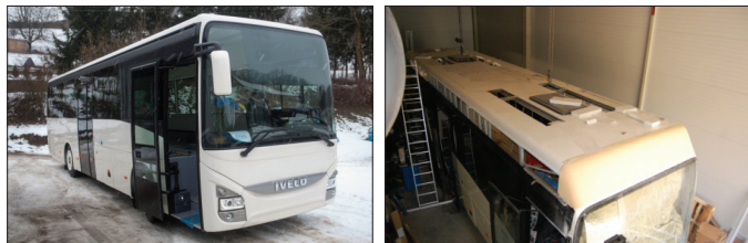
Sliki 1 in 2: Iz Češke uvožen turistični avtobus IVECO; Predelava se prične, povišanje vozila za 30cm
