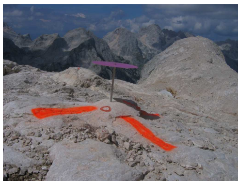
Slika 4: Stabilizirana oslonilna točka iz leta 2001, posneta ob fotogrametričnem snemanju 2003 (foto: Miha Pavšek)
