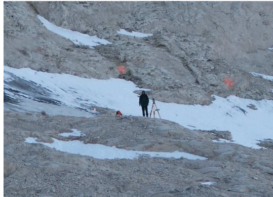
Slika 8: Začasna signalizacija oslonilnih točk okoli ledenika v letu 2007 (foto: Mihaela Triglav Čekada)
