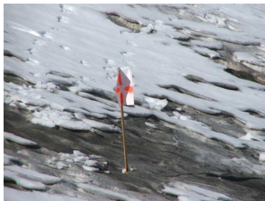
Slika 9: Začasna signalizacija oslonilnih točk na ledeniku v letu 2007 (foto: Mihaela Triglav Čekada)
