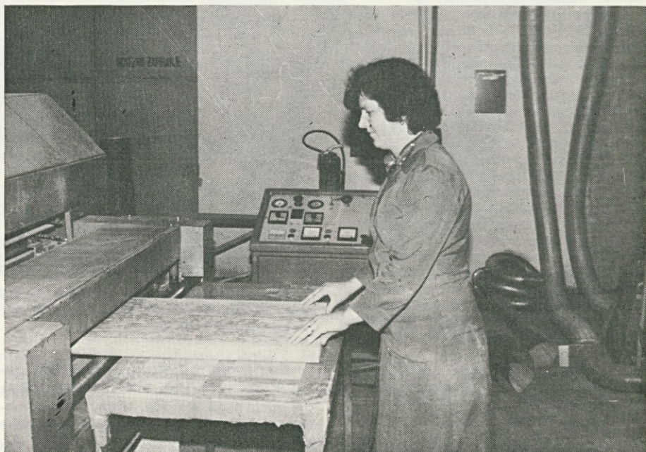
Stroj za brušenje ploskovnih polizdelkov je bil v Slogo pripeljan iz tozda 2. Ko smo napravili posnetek, je delavka pravkar na njem brusila elemente za program Delta.
