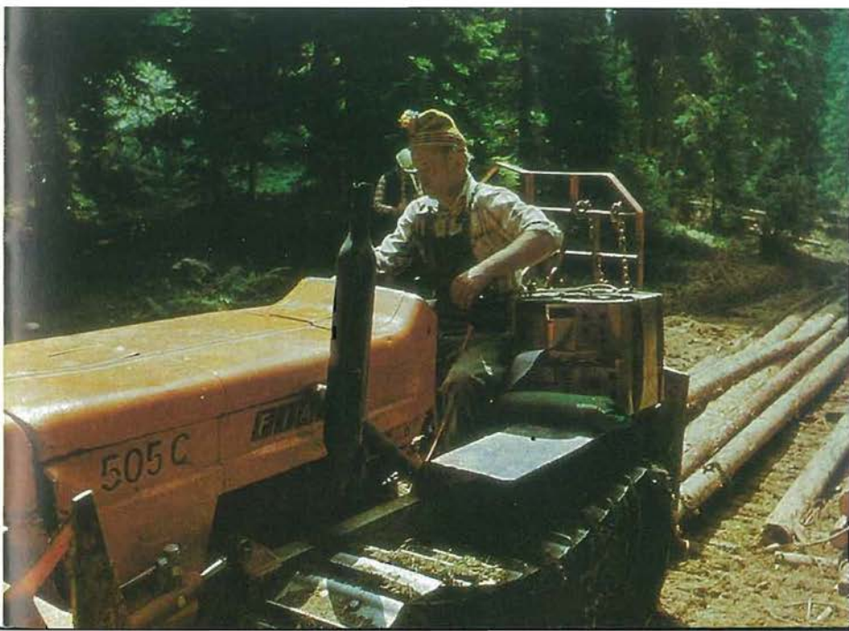
Merjenje vibracij na sedežu goseničnega traktorja FIAT 505 C na Pokljuki (foto B. KOŠIR)
