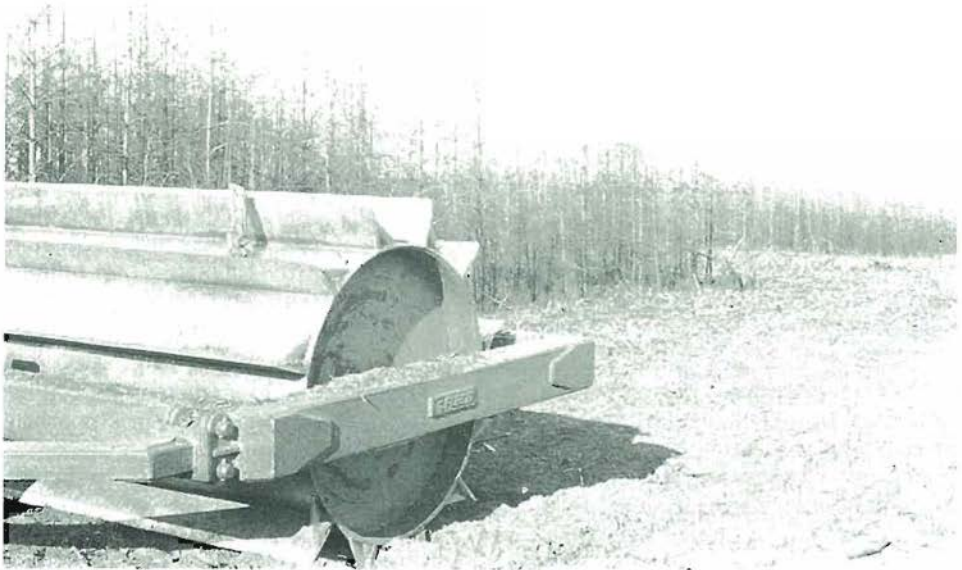
Fleco sekalni valj (15 ton) je namenjen za uničevanje zelene vegetacije na površinah, ki jih pripravljamo za umetno obnovo. Foto M. Hočevar
