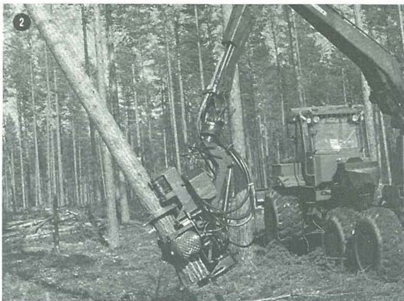
Stroj za sečnjo in izdelavo sortimentov z obdelovalno glavo na hidravlični roki
