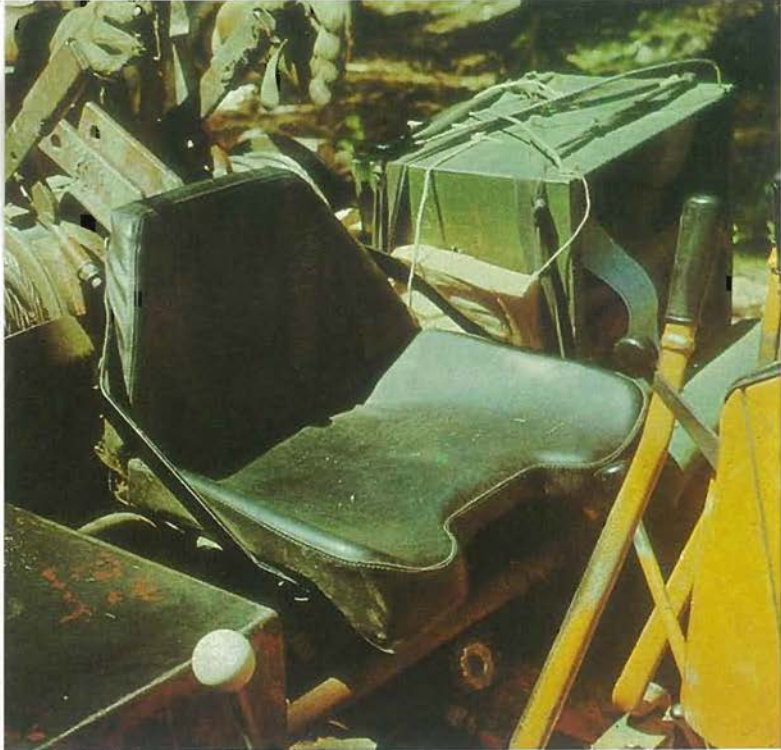
Traktorski sedež na goseničarju dobro duši vibracije, vendar so obremenitve traktorista še vedno izredno velike (foto B. KOŠIR)
