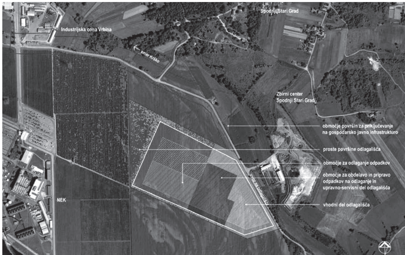
Slika 13: DPN za odlagališče NSRAO na lokaciji Vrbinja v Občini Krško; Ureditvena situacija.
