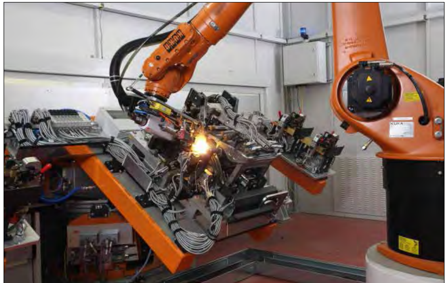
Robotsko krmiljen laserski sistem za varjenje v zelo ozkih mestih, na sestavljenih in kompleksnih orodjih
