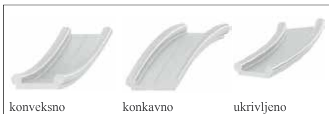
Slika 3. Oblike ukrivljenosti vodil
