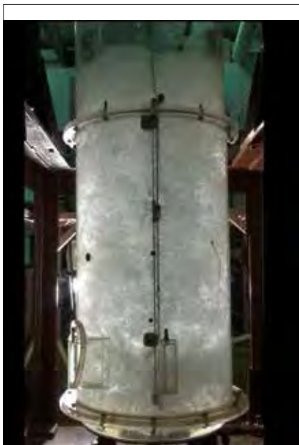
Slika 17. Dispergiranje zraka na mešalni napravi pri 178 vrt/min in pretoku zraka 28,3 m n 3 /h
