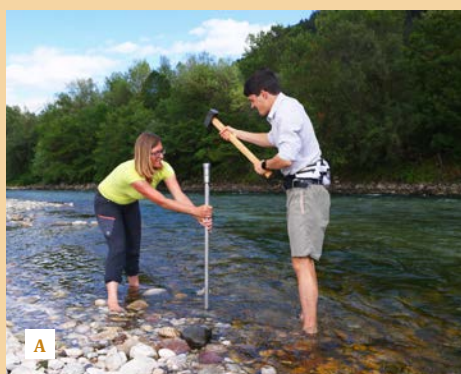
Globlje v prod lahko pridemo z uporabo prenosne votle cevi, ki je na koncu preluknjana. Po zabijanju cevi do izbrane globine (A) s pnevmatično črpalko načrpamo vodo (B) in jo prefiltriramo preko ročne mreže. Ta metoda se imenuje metoda Bou-Rouch. (foto: D. Tome)
