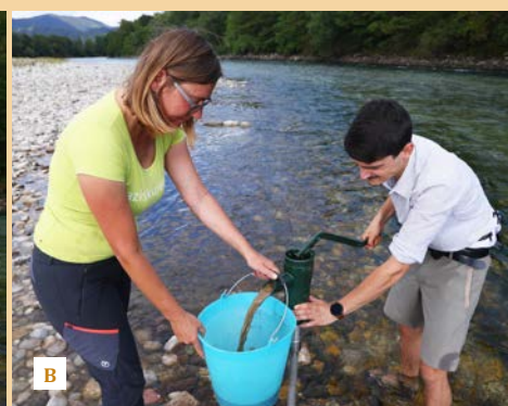
Globlje v prod lahko pridemo z uporabo prenosne votle cevi, ki je na koncu preluknjana. Po zabijanju cevi do izbrane globine (A) s pnevmatično črpalko načrpamo vodo (B) in jo prefiltriramo preko ročne mreže. Ta metoda se imenuje metoda Bou-Rouch. (foto: D. Tome)
