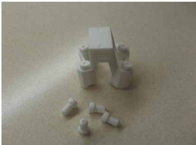
Slika 2: Vodilna šablona za ravni L 3 in L 4, izdelana s tehnologijo hitre izdelave prototipov.
