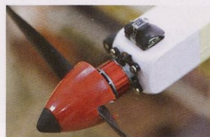
Propeler, brezkrtačni elektromotor, merilnik vrtljajev ter GPS senzor v nosu modela
